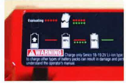
På Sencos lader kan du lese batteriets ladetilstand, samt se om det er feil på det.
