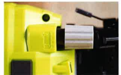
Ryobis hjul til justering av spikerdybde er dårlig, og det er ingen dybdeskala.
