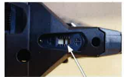
Sencos dykkertpistoler har en tydelig skala, som viser spikerdybden du har valgt.
